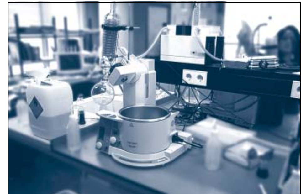
Rotatiefilmverdampers met zelfdrogende vacuümpomp
